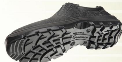
**Solado** Constituído de duas camadas de poliuretano (PU), injetado diretamente no cabedal, sendo a 1ª camada (entressola) mais macia e leve, com densidade de 0,4g/cm<sup>3</sup> proporcionando maior conforto; e 2ª camada (sola) mais compacta com densidade de 0,9 g/cm<sup>3</sup>, resistente a abrasão com sistema antiderrapante constituído de ranhuras especiais de 3mm de altura e 6mm de largura.
